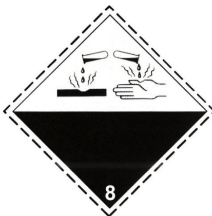
Рисунок 20. Знак опасности «Коррозионное вещество, класс 8»
